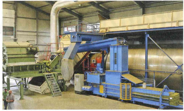
Die Ballenpresse ist fester Bestandteil der Futtertrocknung Lamerdingen. Neben Gras und Luzerne wird auch immer mehr heißluftgetrocknetes Häckselstroh gepresst.
