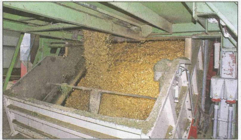
Per Radlader wird der von den Landwirten angelieferte, klein gehäckselte Mais in den Vorratsbehälter eingefüllt, läuft auf einem Förderband weiter und wird in einer Breite von etwa 80 Zentimetern in einen Behälter gefüllt, der den Mais der Trockentrommel zuführt.
